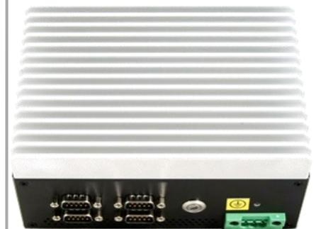
Rückseite mit 4x COM Ports - ON/OFF Taste
